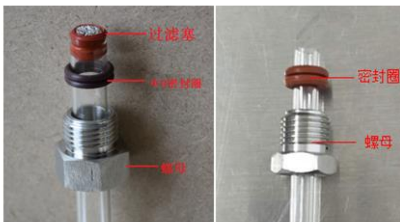
图 6-2-3-2 样品管密封件
